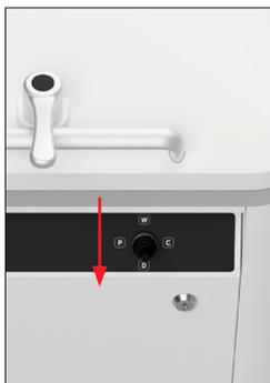
5. После завершения разрезания (через несколько секунд) слегка опустите рабочую поверхность, установив джойстик в положение D
