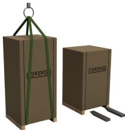
В целях транспортировки машину можно упаковать на поддоне, в коробке или ящике. Упакованную этим образом машину можно поднимать при помощи автопогрузчика или тележки для поддонов, вставив зубцы вилок в специальные отверстия под упаковкой. Либо ее можно поднять при помощи крана, продев тросы или стропы под упаковкой. В этом случае соблюдайте максимальный угол натяжения тросов, который должен быть равен  $45^\circ$ , как показано на рисунке.
