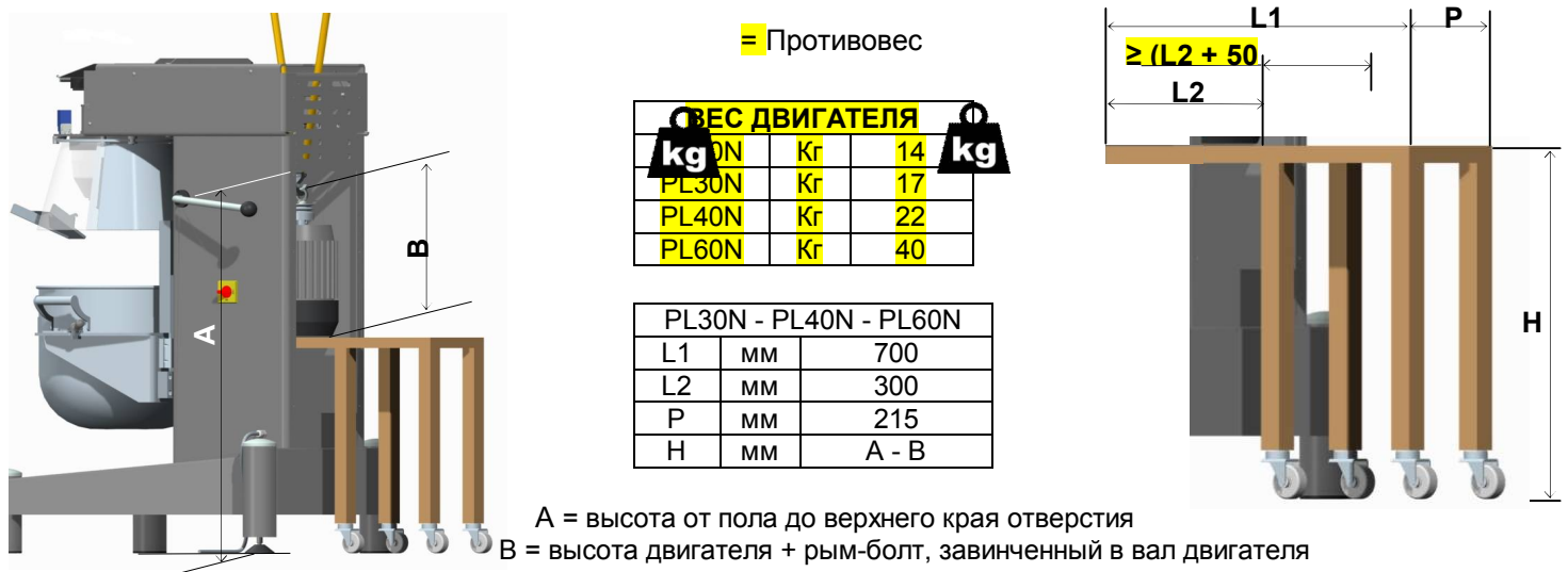
Рисунок 21 – Инструмент для упрощения процедуры установки/демонтажа двигателя
