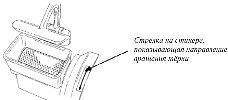
Рис. 10 – Направление вращения вала тёрки
