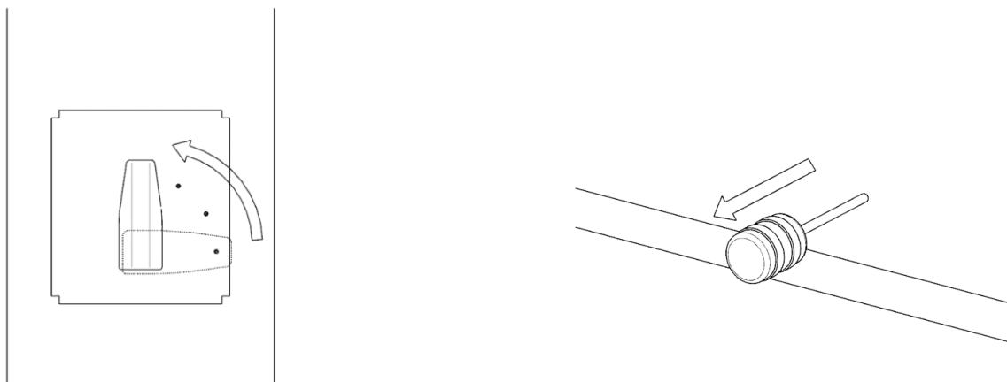
Отверстие для поступления воздуха управляет при помощи регулятора тяги воздуха, расположенного на панели под духовым шкафом. Чтобы открыть воздушную заслонку потяните ручку до упора на себя.
